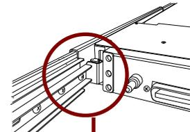
6. Schrauben Sie die beiden Blockierer auf beiden Seiten an der Rückseite fest. Achten Sie auf die Einbaurichtung.
