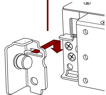
6. Installez 3 vis (longueur 6mm) à l'arrière du terminal LCD, des 2 côtés, pour finir l'installation
