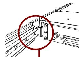
5. Utilisez une vis pour fixer le bloqueur à l'arrière du terminal LCD, des 2 côtés
